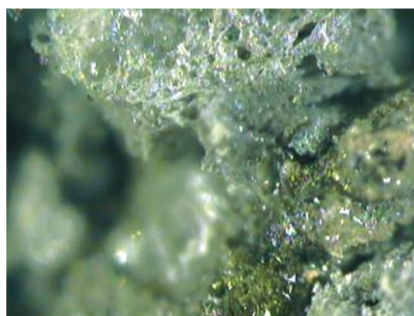
Fot. 15-4. Produkt unieszkodliwiania azbestu pozbawiony struktury włóknistej - ATONIT
