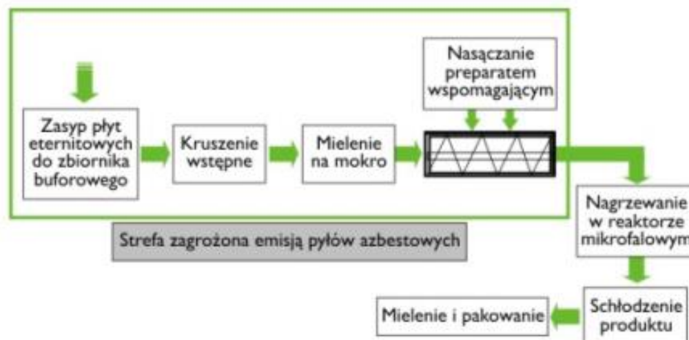
Rysunek 15-1. Schemat blokowy urządzenia ATON 200.
