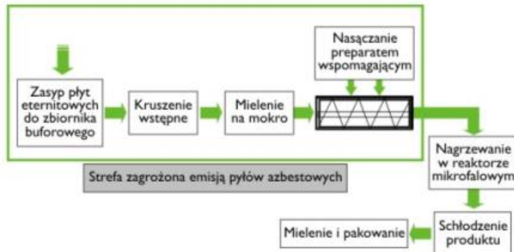
Rysunek 15-1. Schemat blokowy urządzenia ATON 200.
