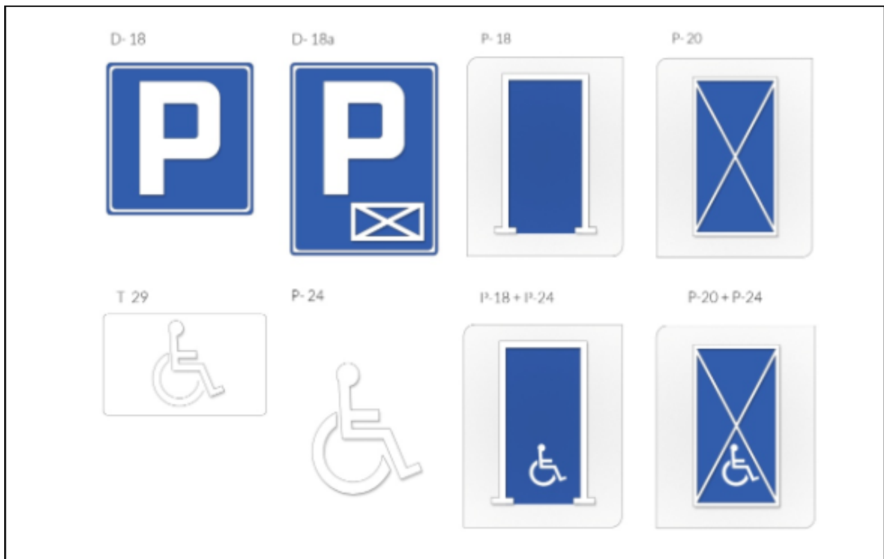
Ryc.12 Oznakowanie stanowisk postojowych
