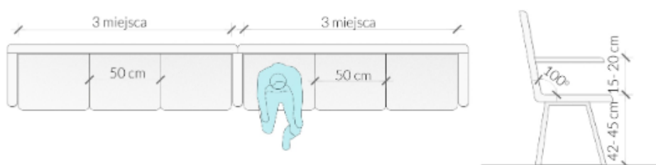
Rys. 28. Wytyczne i wymiary dotyczące ławek
